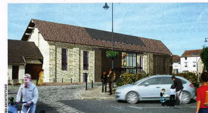
La médiathèque s'installera dans un ancien corps de ferme en pierre, à l'isolation thermique renforcée (ouate de cellulose, panneaux de bois, tuiles plates)...
